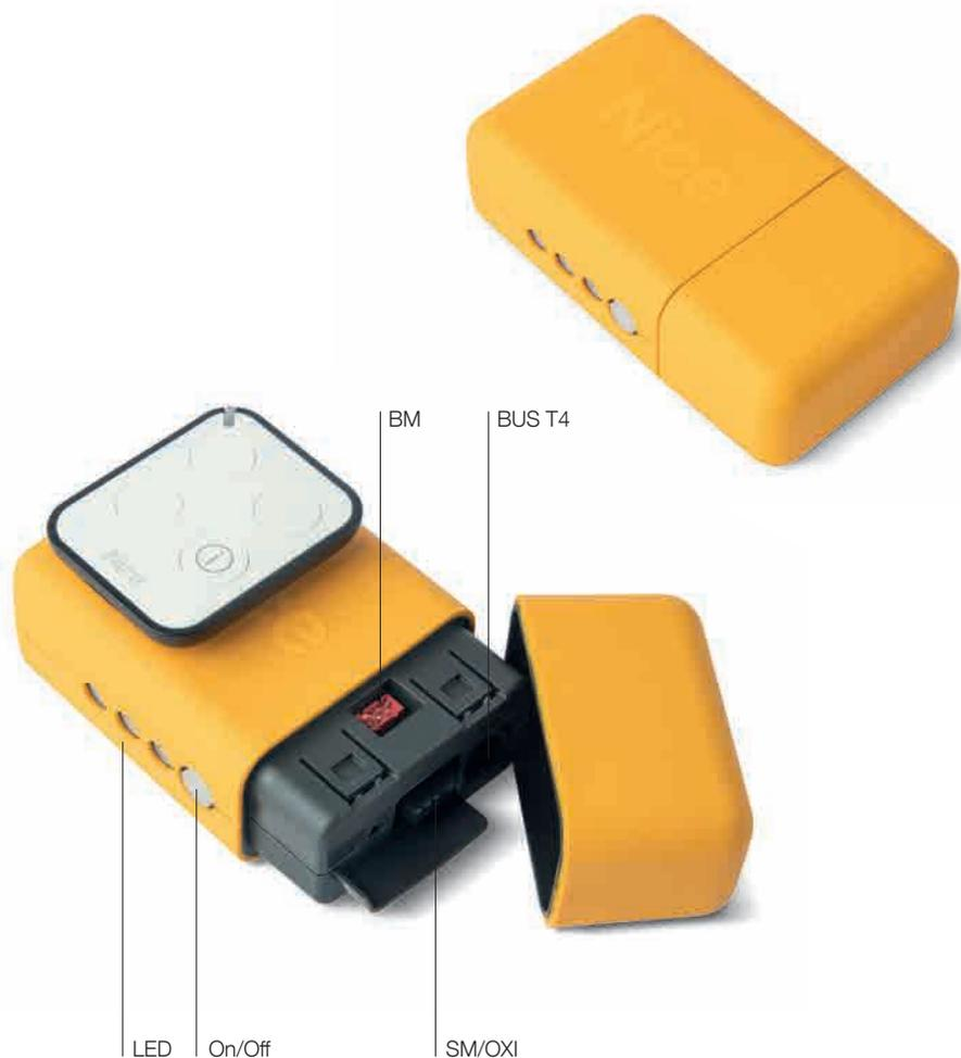
La nuova interfaccia Pro-View si connette alle centrali Nice attraverso BUS T4 e grazie all'App MyNice Pro permette l'installazione e la configurazione da smartphone dei sistemi di automazione Nice.
