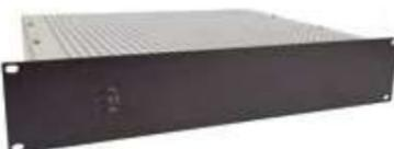
Caricabatterie per sistemi di evacuazione vocale, conforme alla norma EN54-4. Progettato per caricare batterie piombo-acido e alimentare al contempo applicazioni ausiliarie. Comprende 6 uscite di carica con una potenza massima di 3600W. Supporta fino a 3 unità di espansione NEO con 2 batterie da 120 Ah 12 V (batterie non incluse).
