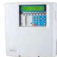
Centrale con loop singolo a triplo circuito, supporta fino a 128 dispositivi loop. La mascherina con icone rende la centrale adatta a tutti i mercati. Unità di alimentazione a 24 V, 2,7 A.
