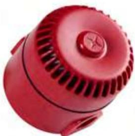
Avvisatore acustico flessibile per sistemi antincendio e di sicurezza, dotato di controllo del volume e 32 toni selezionabili mediante interruttore DIL. Il dispositivo Roshni a basso profilo con base alta offre un grado di protezione IP65. Tutte le sirene Roshni si avviano in modo sincronizzato per garantire l'auto-sincronizzazione senza un terzo cavo.
