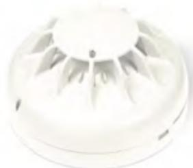
A completamento della gamma, il sensore termico può operare con soglia fissa o in modalità termovelocimetrica. È particolarmente indicato per gli ambienti molto polverosi o quando le condizioni precludono l'uso di rivelatori di fumo.
