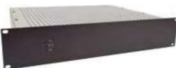
Caricabatterie per sistemi di evacuazione vocale, conforme alla norma EN54-4. Progettato per caricare batterie piombo-acido e alimentare al contempo applicazioni ausiliarie. Comprende 2 uscite di carica con una potenza massima di 960 W. Supporta 1 NEO8060 con 2 batterie da 45 Ah 12 V (batterie non incluse).
