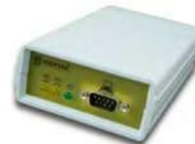
FC500MFI è un'interfaccia multifunzionale utilizzabile tra una centrale FireClass 500 e una stazione dei vigili del fuoco o una scheda di controllo remoto, che può trovarsi fino a 1 km di distanza dalla centrale FireClass 500. Ad ogni modulo FC500MFI è possibile collegare anche una stampante seriale per la stampa di tutti gli eventi che si verificano nel sistema.
