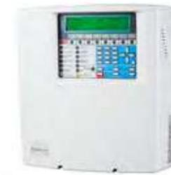
Centrale con loop singolo a triplo circuito, supporta fino a 128 dispositivi loop. La mascherina contiene stringhe di testo in lingua inglese. Unità di alimentazione a 24 V, 2,7 A.
