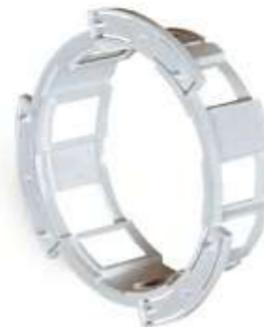
L'adattatore per controsoffitti può essere utilizzato con la base da 4" per montaggio a pressione ed è formato da tre parti: una cornice, un elemento di aggancio da fissare al soffitto e una scatola per l'innesto della base e del rivelatore.
