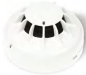
Grazie alla capacità di rilevare numerose tipologie di incendio, da quelli con fiamme vive a quelli a sviluppo lento, questo rivelatore combinato con sensore ottico e termico è la scelta vincente per tantissime applicazioni, tra cui impianti dell'industria leggera, locali commerciali e uffici. Può operare in diverse modalità e sensibilità, selezionabili dinamicamente in funzione delle diverse condizioni ambientali.
