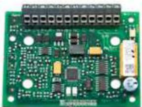
Quando viene attivato da segnali di incendio, oppure da guasti o isolamenti all'interno della zona relativa alla porta tagliafuoco, il modulo FC410TSM interrompe l'alimentazione agli elettromagneti determinando la chiusura delle porte. Il modulo è predisposto per monitorare un contatto e segnalare alla centrale antincendio eventuali problemi di chiusura della porta. È inoltre dotato di un isolatore di linea integrato.
