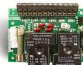
Il modulo booster per avvisatori acustici SB520 permette al modulo FC410SNM di alimentare circuiti con correnti più elevate monitorando al contempo l'integrità della linea a polarità inversa. Non è indirizzabile e richiede un alimentatore locale da 24 Vcc per alimentare un unico circuito di avvisatori acustici polarizzati e soppressi.
