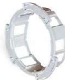
L'adattatore per controsoffitti può essere utilizzato con la base da 4" per montaggio a pressione ed è formato da tre parti: una cornice, un elemento di aggancio da fissare al soffitto e una scatola per l'innesto della base e del rivelatore. Richiede un foro con diametro di 127 mm. La piastra dell'adattatore consente di utilizzarlo con altri dispositivi, ad esempio con la base FC430SB.
