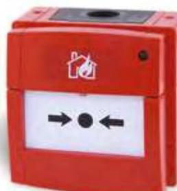
Pulsante di allarme manuale resistente alle intemperie, con LED di allarme integrato e resistenza di attivazione che lo rendono compatibile con la centrale di estinzione Prescient III. Funzionamento a rottura di vetro. Questo punto di chiamata viene montato a vista ed è fornito con scatola da incasso e chiave di prova.
