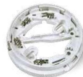
La base con isolatore 4B-I da 4" può essere installata a pressione sull'adattatore per pannelli a soffitto, oppure fissata a soffitto in modo tradizionale. La base 4B-I da 4" è progettata per i rivelatori serie FC460 e fornisce protezione contro i guasti da cortocircuito sui loop indirizzabili digitali.
