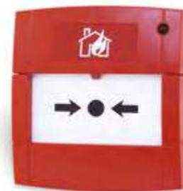
Punto di chiamata manuale convenzionale con LED di allarme integrato e resistore di attivazione. Si attiva tramite un elemento deformabile e ripristinabile. Questo punto di chiamata può essere montato a semi-incasso o in superficie utilizzando la scatola 515.001.021 o 10-115 ed è completo di chiave di prova.
