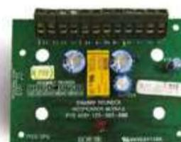
Il modulo di notifica per avvisatore acustico FC410SNM è progettato per fornire un'uscita, controllata da un comando inviato da una centrale, che consente di attivare una serie di avvisatori acustici polarizzati e soppressi. Gli avvisatori acustici sono alimentati esternamente e il modulo è in grado di commutare un carico fino a 2 A (es. avvisatori acustici dal nostro portfolio a 24 Vcc a 50 mA o un mix di avvisatori acustici con correnti nominali diverse complessivamente non superiori a 2 A).
