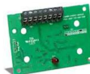
Il modulo di ingresso per contatti indirizzabili FC410CIM è progettato per monitorare contatti antincendio come quelli che controllano il sistema di estinzione, la ventilazione e le porte tagliafuoco. Può essere configurato nelle seguenti modalità:
