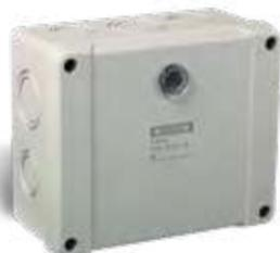
L'interfaccia relè ad alta tensione HVR800 è un modulo relè multitemperatura non indirizzabile (con funzionamento a 24 Vcc, 24 Vac, 120 Vac e 240 Vac). L'unità incapsulata HVR800 fornisce un contatto senza tensione tarato a 10 A che può essere utilizzato per ampliare la portata dei contatti nelle applicazioni che impiegano il modulo relè indirizzabile FC410RIM.
