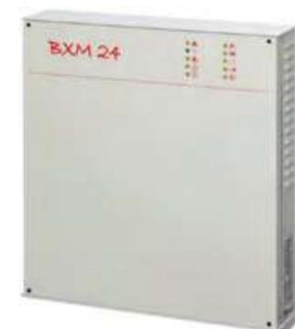
Le unità di alimentazione BXM24/25-U e 50-U possiedono la certificazione IMQ secondo le norme EN 54-4:1997 + A1:2002 e EN60950-1:2001. La custodia in acciaio contiene un alimentatore a commutazione da 2,5 A o 5 A e una scheda di monitoraggio e offre spazio sufficiente per 2 batterie al piombo stagne da 12 V, 17 Ah. I 10 LED del pannello anteriore indicano in modo dettagliato lo stato dell'unità.
