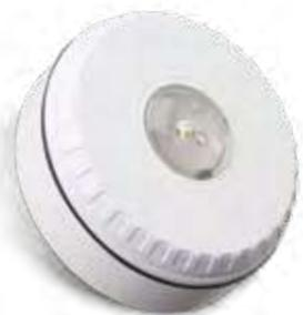
L'avvisatore ottico da soffitto Solista LX è dotato di una lente dal design esclusivo che crea un volume di copertura cilindrico per ottenere l'illuminazione richiesta specificata dalla norma EN 54-23. Installabile fino a 3 metri di altezza ed esteticamente discreto, il dispositivo è ideale per diverse tipologie di applicazioni.
