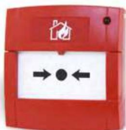
Punto di chiamata manuale convenzionale con LED di allarme integrato e resistore di attivazione. Funzionamento a rottura di vetro. Questo punto di chiamata può essere montato a semi-incasso o in superficie utilizzando la scatola 515.001.021 o 10-115 ed è completo di chiave di prova.
