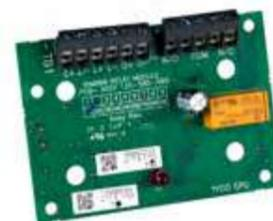
Il modulo interfaccia relè FC410RIM fornisce un contatto relè in scambio senza tensione su un relè bistabile. Il relè è controllato da un comando inviato dalla centrale antincendio FireClass attraverso il loop indirizzabile.
