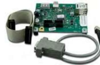
Il modulo IP FC500IP v3 permette la connessione delle centrali della serie FireClass 500 alla rete LAN. Inoltre, se si dispone di un indirizzo IP pubblico, è possibile gestire e monitorare la centrale da qualunque parte del mondo con un semplice accesso alla rete Internet.
