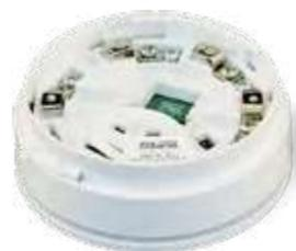
La base relè serie 600 fornisce contatti a doppio relè per la segnalazione a dispositivi esterni in sistemi di rivelazione convenzionali. Il bassissimo assorbimento di corrente, anche a relè eccitato, permette l'uso della base relè senza alimentazione aggiuntiva. I contatti del relè si attivano quando il rivelatore entra in condizione di allarme.
