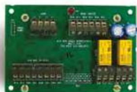
Il modulo I/O multiplo FC410MIO presenta tre ingressi e due uscite da relè bistabile. Gli ingressi possono monitorare i contatti antincendio come quelli che controllano il sistema di estinzione, la ventilazione e le porte tagliafuoco. Le due uscite relè forniscono contatti relè in scambio senza tensione.
