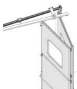
Ribaltamento ante a 90° Wings folding to 90° Faltung des Flügels zu 90°
